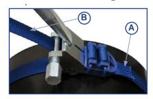
3 - Posizionare lo strumento di tensione e far passare la cinghia (B) (dal lato più lungo) nella fessura dello strumento.
