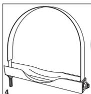
Fixer les sangles "A" sur les Supports "B" avec les rondelles "C" et les écrous Nylstop "D".
