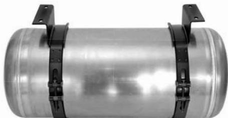
3- Posizionare correttamente le cinghie in acciaio « **SULLE** » supporti stampati e « **SULLE** » cinghie in plastica. Serrare con chiave a brugola n° 6.
