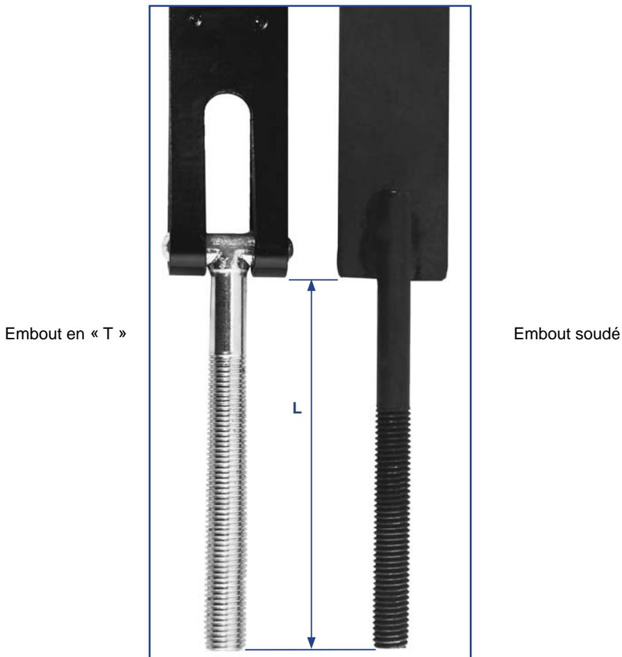
Tous nos colliers sont livrés en « STANDARD » avec un embout soudé, la solution la plus économique. L'embout amovible en « T » permet de réduire l'encombrement de l'ensemble des emballages de 120 à 150 mm (L).
