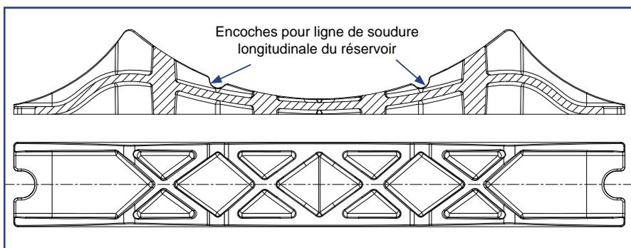
Ce support composite peut entrer directement en contact avec les réservoirs du fait de sa composition et respecter la norme 87/404/CE.
