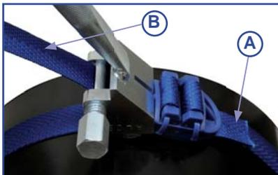
3 - Das Spannwerkzeug ansetzen und das Band **B** (das längere Stück) in den Schlitz des Werkzeugs führen.
