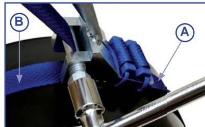
4 - Das Band mit einem 19er-Schlüssel auf ca. 60 Newton-Meter anziehen. Danach das Band beidseitig der KLEMME auf 30 mm (Minimum) kürzen (\*).
