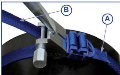
3 - Mettre en position l'outil de mise en tension et passer la sangle **(B)** (coté le plus long) dans la fente de l'outil.
